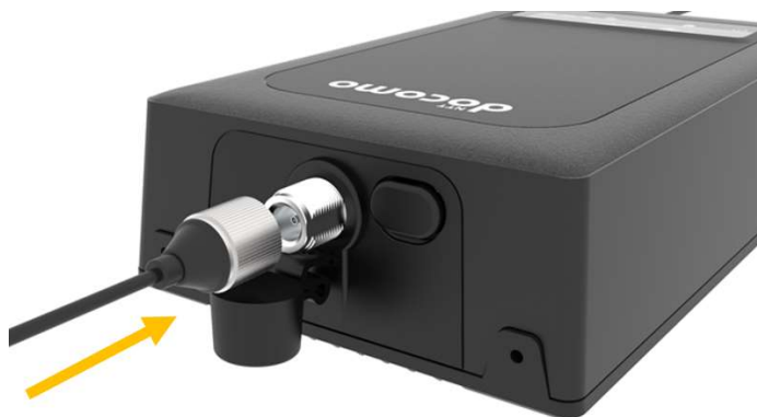
図 30 接続ケーブルの接続
