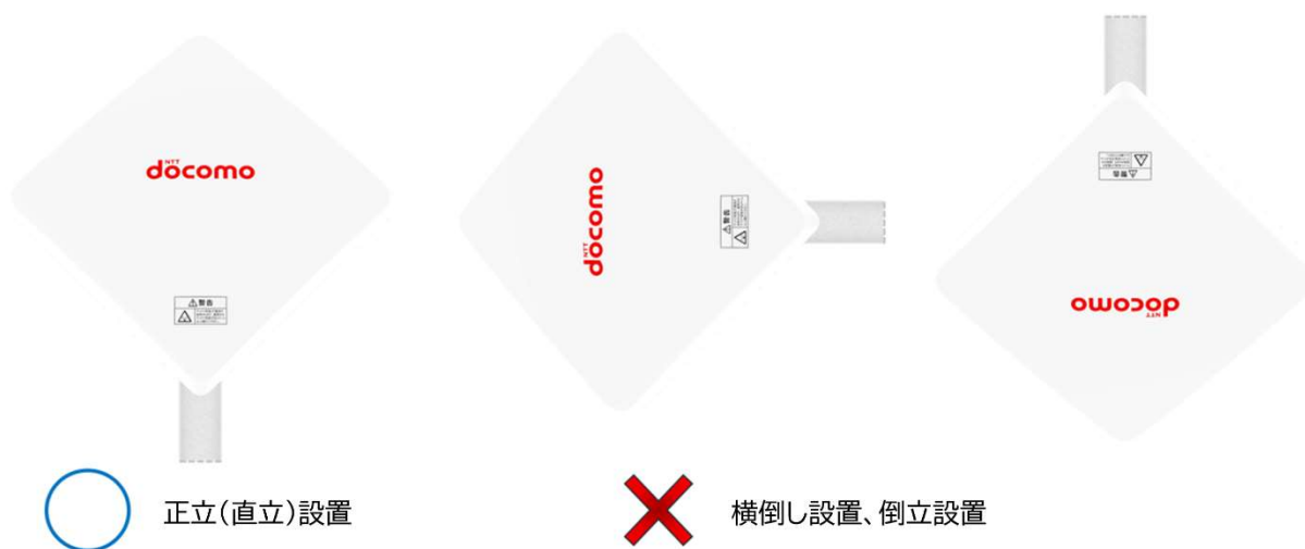
図 18 屋外設置アンテナの取付け向き
