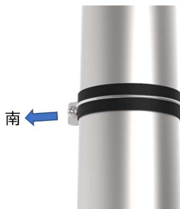
図 20 滑り止めバンドの取付け
