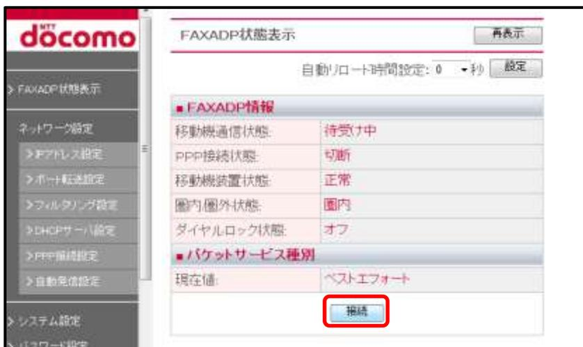
(7) 「衛星回線へ接続します。よろしいですか?」のコメントが表示されるので、『OK』ボタンを押下します。
