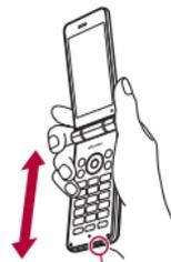
外部接続端子の水抜きのために外部接続端子を下にして振る
